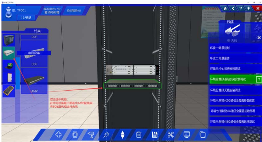
图 4-5 AMP 配线架安装
